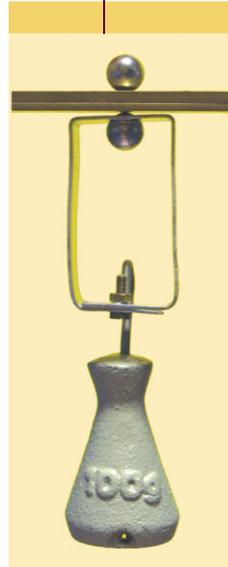
Messung der Haltekraft bei Magnetkugeln.
